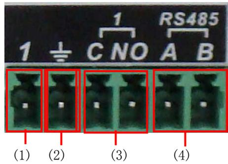
(1) alarm input 1                      (2) grounding                      (3) alarm output1                      (4) RS485
